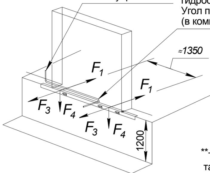
Нагрузки на пандус и бетонное основание
